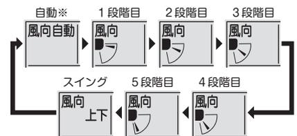
※風向自動は快適自動運転のみに使用できます。運転モードに合わせて自動でフラップ位置を調整します。
