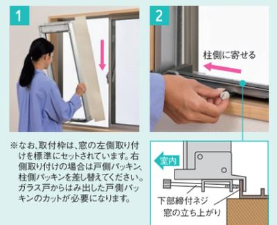
2 取付枠上部を引き上げ固定します
