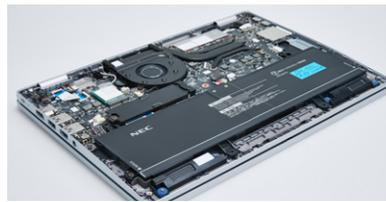
大容量バッテリーを搭載。さらに、「ロングバッテリーモード」により、かきこく消費電力を抑えて長時間使用できます。
