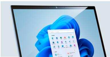
液晶部分にガラス素材を採用することで、より鮮やかな表示を実現。また、強度に優れた「Corning® Gorilla® Glass」を使用することで、液晶部分の保護にも役立っています。
