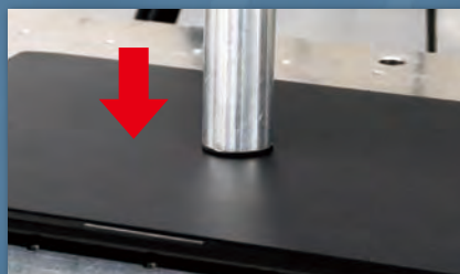
天板からの一点加圧試験
