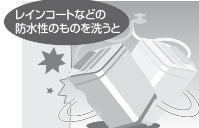
●本体の激しい振動・転倒による壁などの損壊
