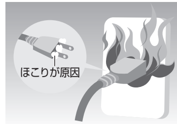
●電源プラグからの発火 (トラッキング現象)
