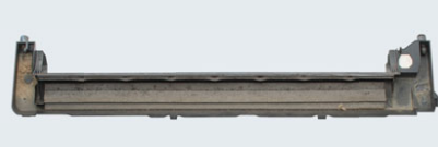
汚れた排水トレー
