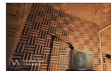
半無響試験室での騒音測定。 低騒音を目指したモノづくりを行っています。
