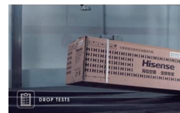
あらゆる角度からの落下試験を行い、梱包品質の 確認を行っています。
