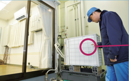
環境試験装置(ルームエアコン) 高温から低温まで条件を作り出し、製品の信頼性確認を行います
