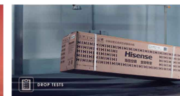
あらゆる角度からの落下試験を行い、梱包品質の 確認を行っています。
