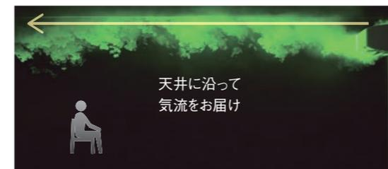
\*画像は、試験のため煙とレーザー光線を用いて気流を可視化したものです。室温安定時、2021年ATR40YPE9と同等機種(AN40WRP)、風量「自動」
