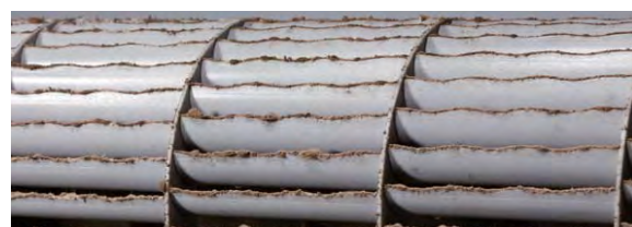
ホコリの溜まったファンの羽根先端部 （約2年間使用したエアコンの一例。使用状態や環境により異なります。）
