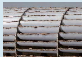
ホコリの溜まったファンの羽根先端部 (約2年間使用したエアコンの一例。 使用状態や環境により異なります。)
